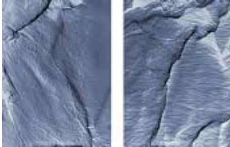
Bild 1 TEM-Oberflächenabdruck eines Eukalyptuszellstoffes, hergestellt nach dem MILOX-Verfahren.
