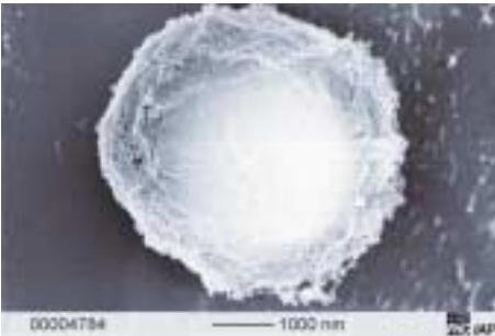
Bild 2 Elektronenmikroskopische Aufnahme eines umhüllten Hydrogelpartikels.
