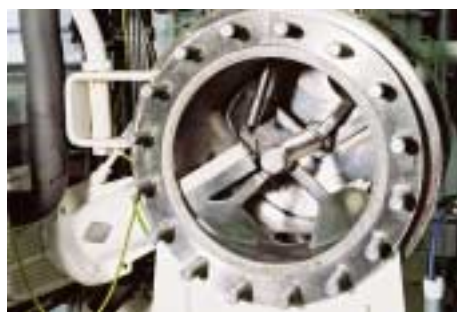
Explosionsgeschützter Reaktor für Celluloseverarbeitung.
