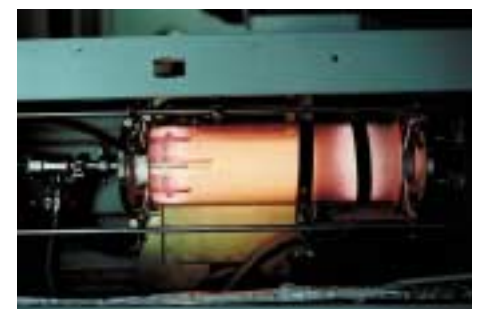
Niederdruckplasma zur Oberflächenbehandlung.
