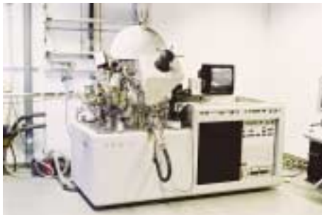
Röntgen-Photoelektronen-Spektroskopie (XPS) zur chemischen Oberflächenanalyse.
