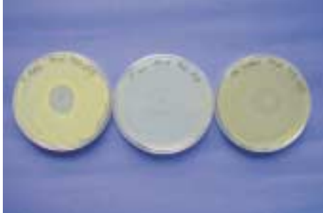
Hemmhoftest zur Prüfung der antimikrobiellen Wirksamkeit.
