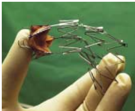
Gefäßstütze aus Memory-Metall zur Einbringung von Bioherzklappen, Fraunhofer IOF.
