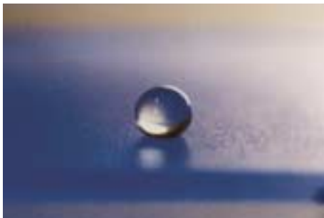
Wassertropfen auf hydrophobierter Polymeroberfläche.
