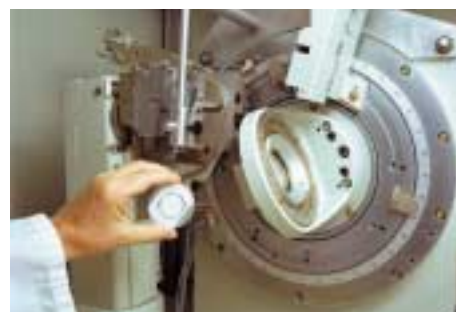
Röntgen-Zweikreisdiffraktometer zur Bestimmung übermolekularer Strukturparameter.
