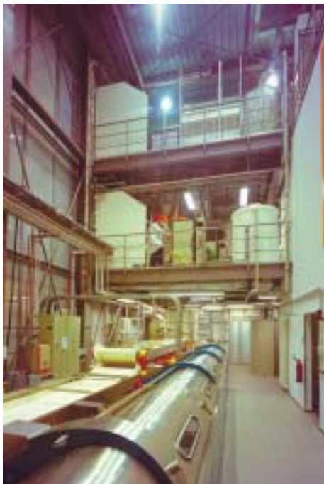
Pilotanlage zur Herstellung von Celluloseblasfolie.
