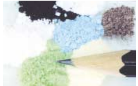
Aminoharzkapseln mit festen oder flüssigen Inhaltsstoffen.
