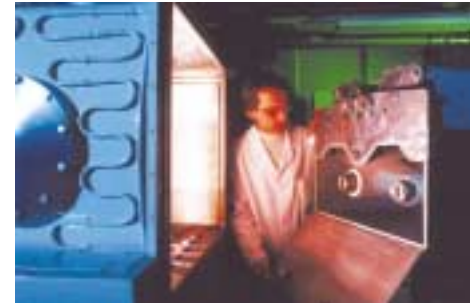
Plasma-Anlage zur semi-kontinuierlichen Behandlung von Bahnware.
