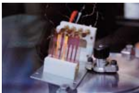
Organische Leuchtdioden in der Glovebox.
