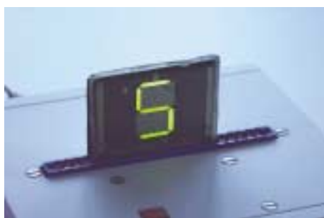
Sieben-Segmentanzeige auf Polymerbasis.
