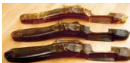
Bild 2 Bauteilmuster Armatureträger aus Newcell-PP-Granulat.
