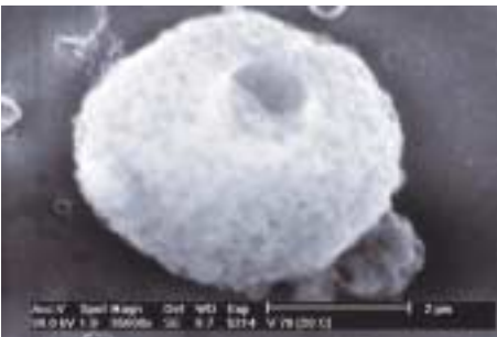
Bild 3 Elektronenmikroskopische Aufnahme eines umhüllten Partikels nach Temperaturbelastung.
