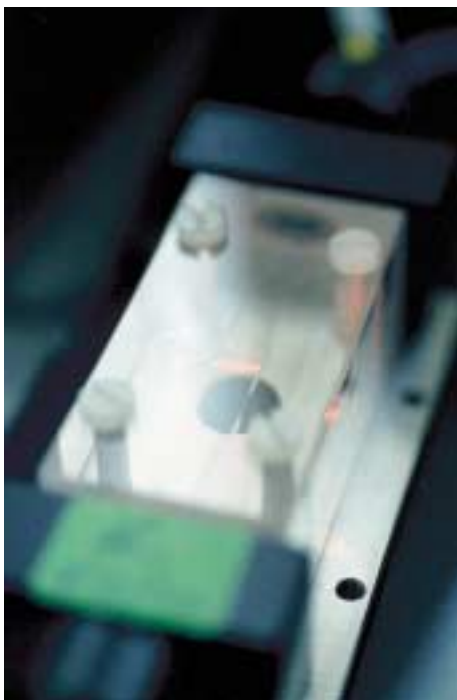
Partikelektrophorese zur Messung der Teilchenmobilität.
