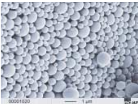
Bild 2 Elektronenmikroskopische Aufnahme von Poly-D,L-lactid (D,L-PLA) - Submikronpartikeln.
